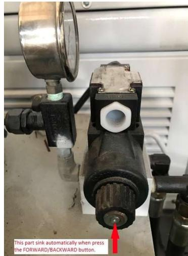
自動的に沈む場合は、電磁弁が正常であることを意味します。手順(3)へ移動します。
